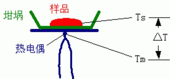
如上图所示，由于坩埚热阻等因素，在样品实际温度  $T_s$  与热电偶检测到的温度  $T_m$  之间存在着一定的温度差  $\Delta T$ 。因此在实际的测量中，对热电偶测量值  $T_m$  必须经过一定的修正（扣除  $\Delta T$ ），才能得到样品的真实温度  $T_s$ 。
