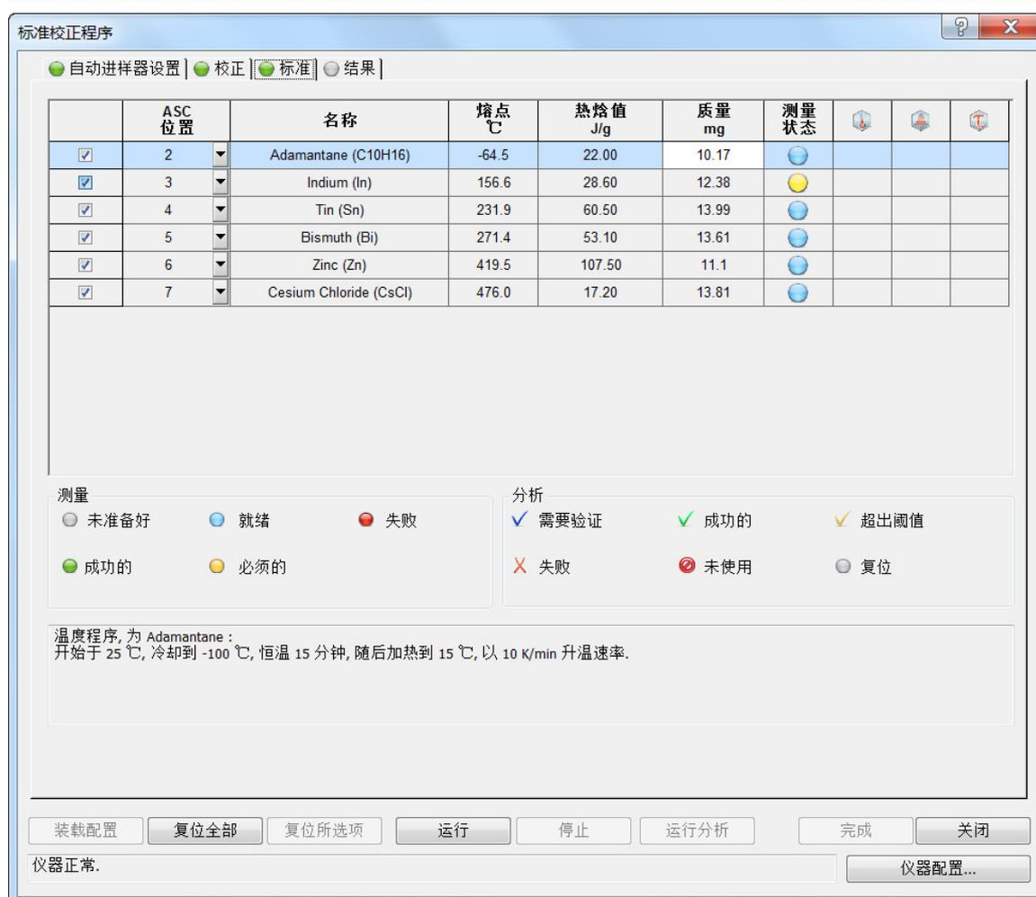
点击运行，系统会通过自动进样器放入标样，然后自动执行测试程序，所有标样测试完成后自动生成校正文件。
