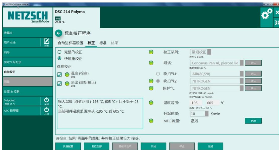
此处以“完整的校正”为例，选择“校正系列”如“DSC kit, Concavus pans, 6 references”使用 DSC214 自带的一套标准样品 (C<sub>10</sub>H<sub>16</sub>、In、Sn、Bi、Zn、CsCl) 进行校正，选择“坩埚类型”如 Concavus Pan Al, pierced lid，设定“吹扫气和保护气”类型如氮气，设定“温度校正范围”(最大范围-195 °C~605 °C，根据实际情况设定)，选择“升温速率”如 10K/min。
